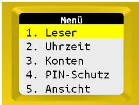
Mit den Pfeiltasten können Sie durch das Menü navigieren. Mit der **OK-Taste** gelangen Sie in das jeweilige Untermenü. Mit der **C-Taste** verlassen Sie das Untermenü. Sie können auch die entsprechende Ziffer des Menüs über die Tastatur auswählen, Sie gelangen dann direkt in das jeweilige Untermenü.
